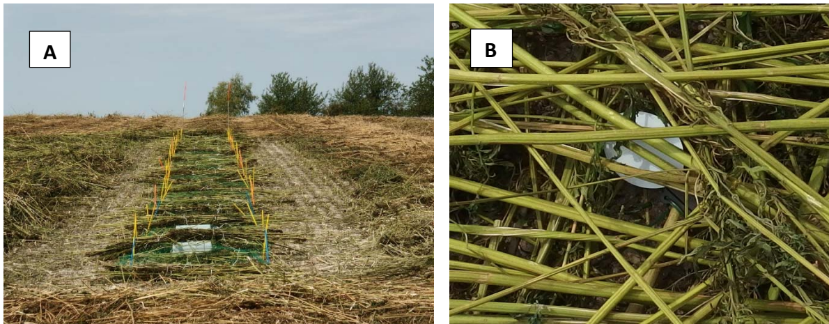
Figure 1 : A) Dispositif expérimental pour le suivi du rouissage au champ ; B) Capteur de rosée inséré dans les pailles de chanvre, en 2017.
