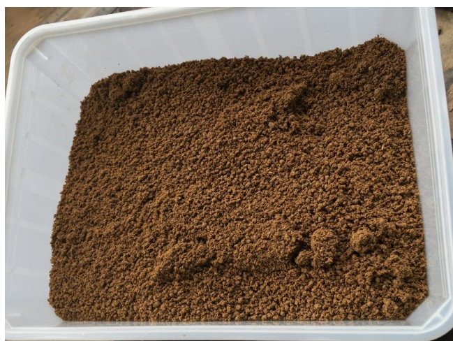
Figure 1 - Terre brute tamisée à 2 mm par l'automate
