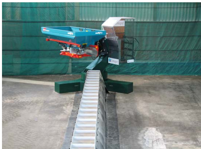
Figure 2 : Dispositif CEMIB de mesure des densités d'engrais distribuées au sol par un distributeur centrifuge.
