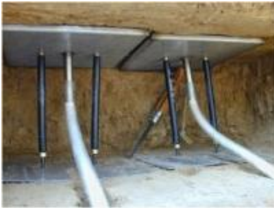
Figure 4: Lysimètres ouverts avec mèche en fibre de verre ; source : INRA
