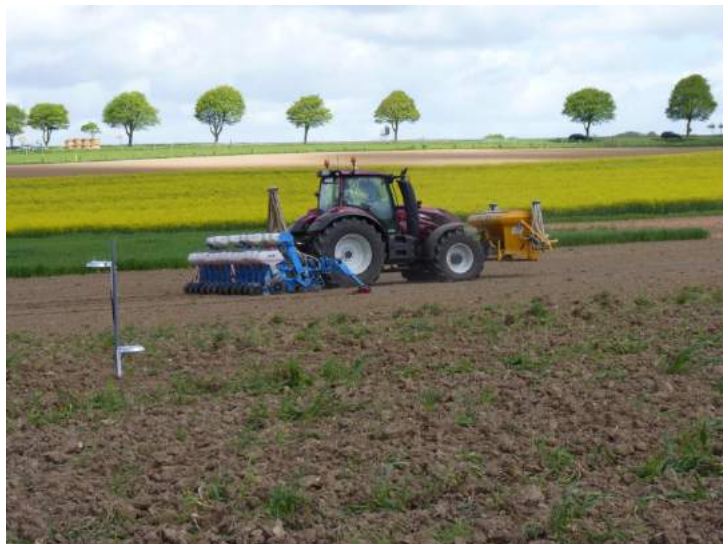
Semoir de précision avec localisateur d'engrais (Monosem NGplus 4) - enfouissement par les disques (3-4 cm)
