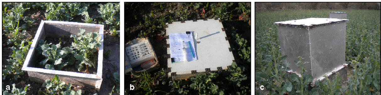
Photo 1 – Chambre manuelle statique en place sur colza : hors séance de mesure (a) et pendant séance de mesure sans (b) et avec rehausse (c). Crédit photo Y. PYTHON.
