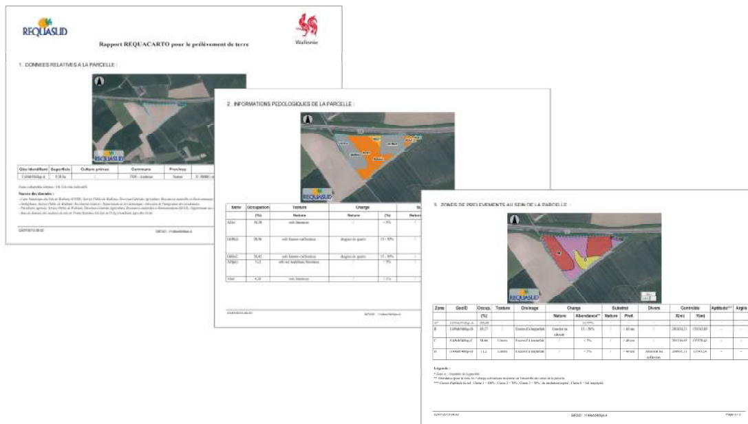
Figure 4 - Exemple de rapport pour le prélèvement de terre fourni par le logiciel REQUACARTO.
