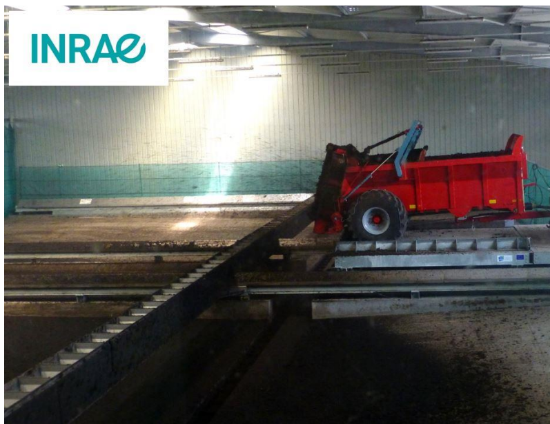
Figure 1 : Photo du banc CEMOB INRAE permettant la mesure simultanée des courbes RT et RL.
