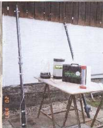
Le Quantifac comme l'Agron-lisier permettent d'éviter la friction atmosphérique des lisiers de porcs. On remarque à gauche la sonde de prélèvement.
