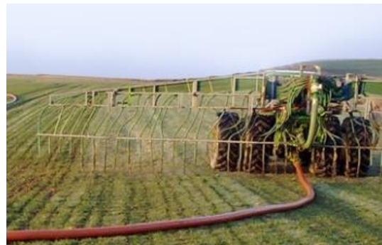
Epandeur à pendillard sans tonne sur culture
