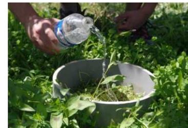
Verser de l'eau...jusqu'à mesurer un temps d'infiltration constant
