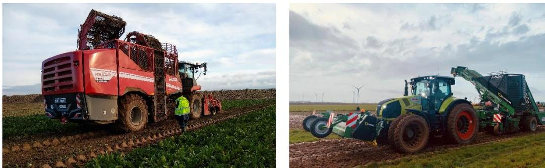
Figure 3 : Illustration d'une intégrale de récolte (à gauche) et d'un chantier décomposé (à droite)
