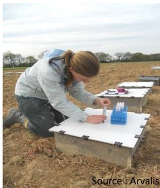
**Photo 2 :** Réalisation des prélèvements d'échantillons gazeux au terrain permettant de déterminer le flux d'émission de N<sub>2</sub>O
