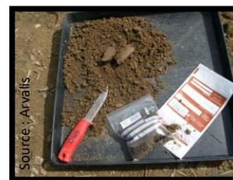
**Photo 3 :** Constitution d'échantillons composite de sol pour la détermination des variables auxiliaires
