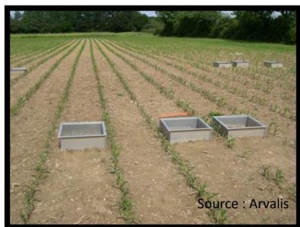
**Photo 1 :** Dispositif expérimental sur le domaine de la Jaillière avec des embases au sol pour les mesures d'émission de N<sub>2</sub>O
